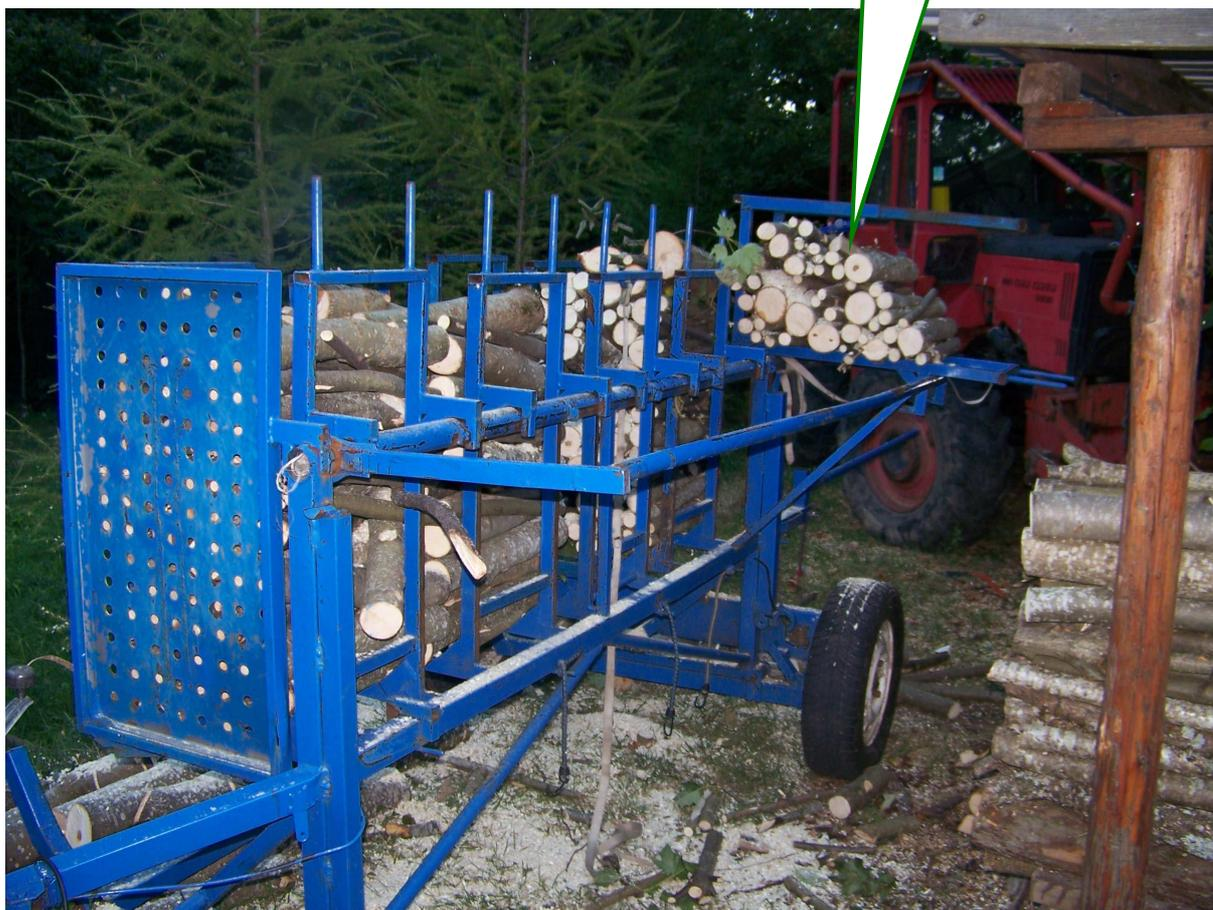
barre de gabarit pour la coupe des bouts qui dépassent. Cette barre se replie à l'intérieur d'un tube
