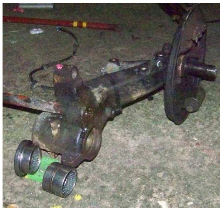
Coté droit remplacement de l'essieu, avec deux douilles à aiguilles neuves, récupération d'une douille encore en état provenant du coté gauche qui va venir renforcer un peu le montage.
